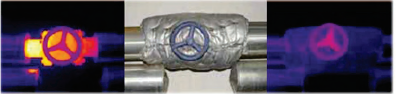
Şekil 14: Yalıtımlı ve Yalıtımsız Vana Isı Kayıpları
